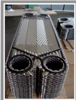
Vicarb-V13-Platten nach der Rekonditionierung. Vorbereitet für die Versendung zum Einsatzort in einem Kraftwerk der Vattenfall-Europe-Mining AG.
