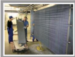
Service zu einem Plattenwärmetauscher vom Typ APV-K71 für die größte Privat-Brauereigruppe in Deutschland. Reinigung, Kontrolle der Platten und das Anbringen der Dichtungen wurden in unserer eigenen Arimex-Werkstatt bei Arimex Polska s.c. durchgeführt. Die Montage der Platten und die anschließende Druckprüfung wurden vor Ort beim Kunden erfolgreich abgeschlossen.
